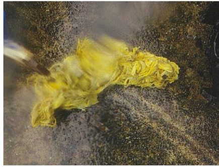
農村下水道処理施設のポンプに絡まっていた布類（2023年6月）
